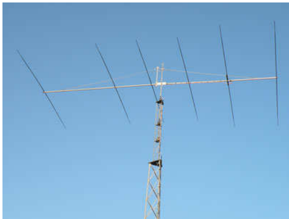
Figura 18 - Yagi de 6 elementos: quatro diretores e um refletor. O dipolo principal é o segundo, da direita para esquerda. Note o tamanho da “gondola” que sustenta os dipolos: 8m
