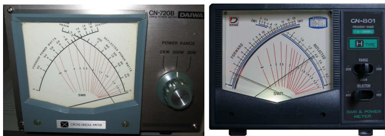
Figura 11 - Medidores de estacionária comercial, fabricados pela Daiwa Co. A escala esquerda mede a potência direta e a escala direita a potência refletida.
