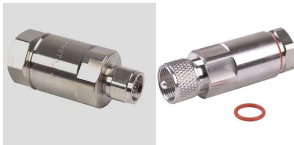
Figura 27 – conectores: tipo "N" e "UHF" para cabos rígidos tipo Heliax ou Cellflex. À esquerda, para cabos 7/8" e o outro para cabos de 1/2"
