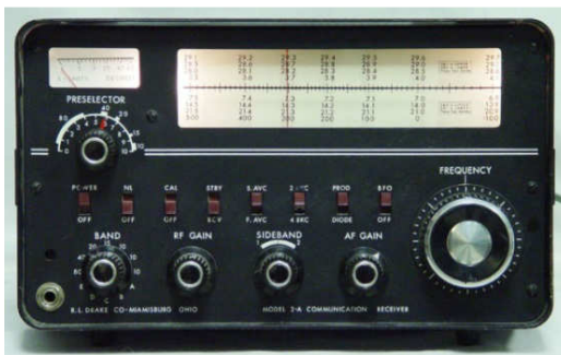
Figura 8 - Rádio receptor da marca Drake, modelo 2A. O dial tinha o indicador vertical que deslizava à medida que o botão grande, chamado de VFO ou (frequency) era movimentado.
