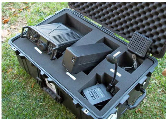
Figura 2 – Exemplo de uma estação simples: rádio e fonte. Faltam: a antena e acessórios na foto. (cortesia de K2BSA & ICOM Inc. – IC-7200, OS-126 & SM-50).
