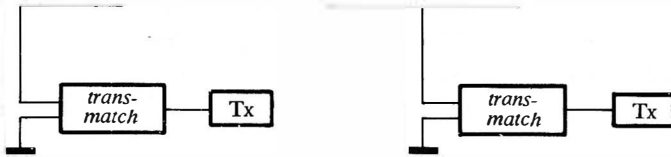
Fig. 7.28 Antenas L-invertido e T como irradiantes verticais.
