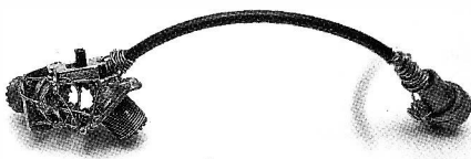
Fig. 5.10 Comutador miniatura usado como chave de antena em UHF.
