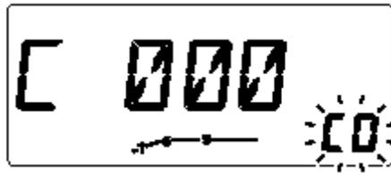
4) Aperte [MW(S.MW)] para ajustar o modo de programação de código.
