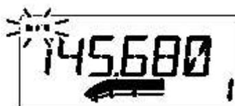
3 Aperte [FUNC] e depois [PRIO 3(PTT-M)] para desativar a função de PTT com um toque.
