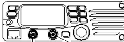
**Ajuste os controles VOL e SQL nas posições de 9-10 horas.**
